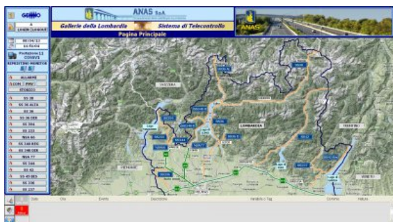
Obr. 2. - Systém pro dohled a řízení na dálku, navržený a implementovaný společností Gemmo S.p.A., je založen na SCADA PcVue od firmy ARC Informatique
