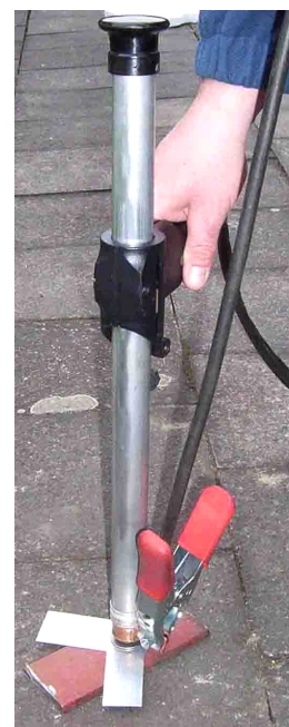
průvarová pistole s kostřením na hubici
