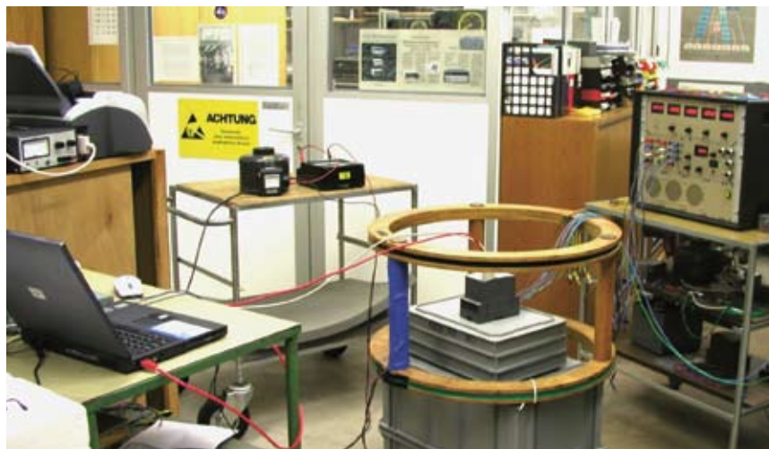
Měření chování přístrojů vystavených magnetickému poli, které se vytváří pomocí Helmholtzovy cívky
