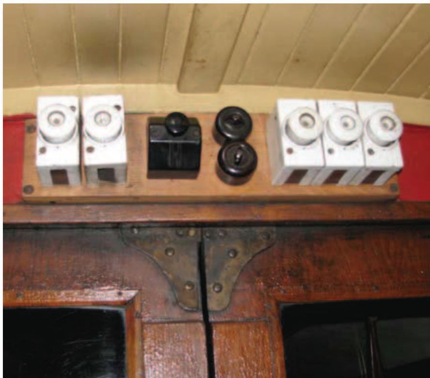
Hlavní silnoproudé pojistky vozů tramvají typu 350.358 od roku 1915.
